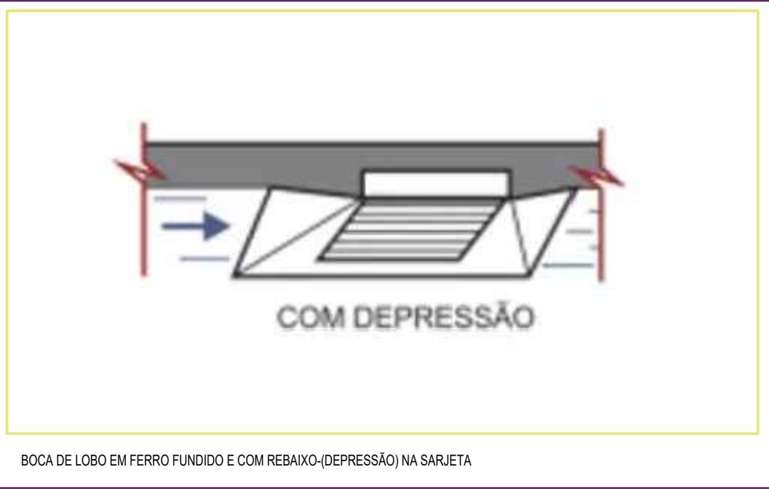
BOCA DE LOBO EM FERRO FUNDIDO E COM REBAIXO-(DEPRESSÃO) NA SARUETA
